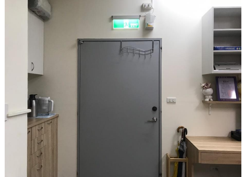
H101 前門設置緊急出口標示及照明設備，供避難逃生時使用。
